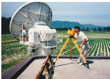
写真-14 EL 軸の高さを決めるため、新十津川人工衛星観測室の屋上で水準測量を行なう唐沢正夫。1990年7月
