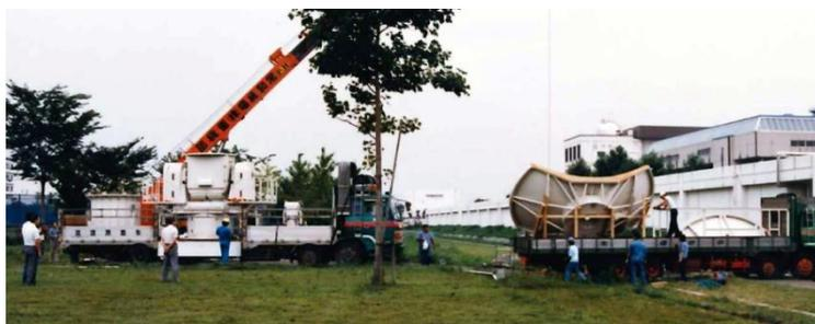
写真-5 2台のトラックに積み込まれた5mアンテナ。左のトラックには架
