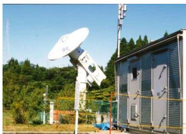
写真-23 2.4mの小型アンテナ。砺波(富山県)、1994年11月。架台は水蒸気ラジオメータの架台を利用した。写真の右側は1992年に導入した車載型コンテナ。可搬型水素メーザとK-4システムの開発により、装置が小型化されコンテナ収納が実現した
